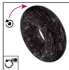
La herramienta Desplazamiento de cámara 3D gira la cámara alrededor del eje Z.
