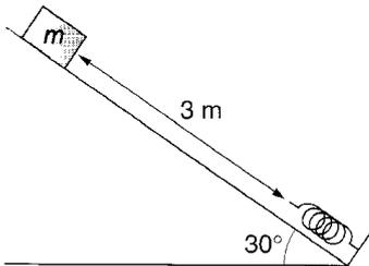
Si no hay pérdidas de energía mecánica debidas a rozamiento o al choque con el muelle y tomando como referencia de la energía potencial inicial el nivel del muelle una vez deformado, la energía potencial en lo alto del plano inclinado se transforma íntegramente en energía potencial elástica.
