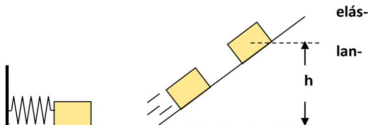
En el punto inicial el cuerpo tiene energía potencial (elástica) debida a la acción del muelle.
