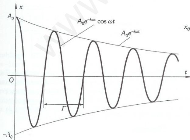
El movimiento vibratorio amortiguado como función del tiempo cuando  $\varphi = 0$ . Las curvas envolventes son  $A = A(t)$ .
