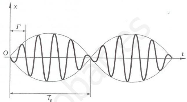
Superposición de dos MAS de frecuencias parecidas. Las líneas envolventes corresponden a la función de modulación.
