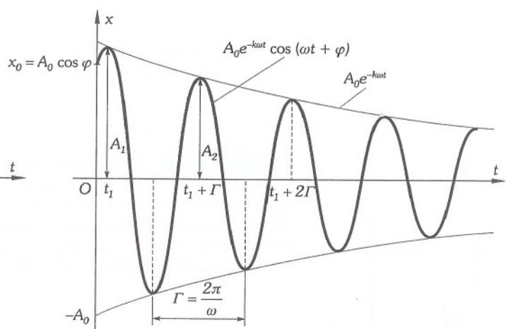
El movimiento amortiguado como función del tiempo cuando  $\varphi \neq 0$ . Obsérvese la disminución continua de su amplitud.
