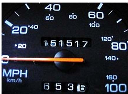
Figura 2.7. El velocímetro indica la rapidez y el odómetro el \Delta \ell recorrido (151517 total, 6536 parcial).
