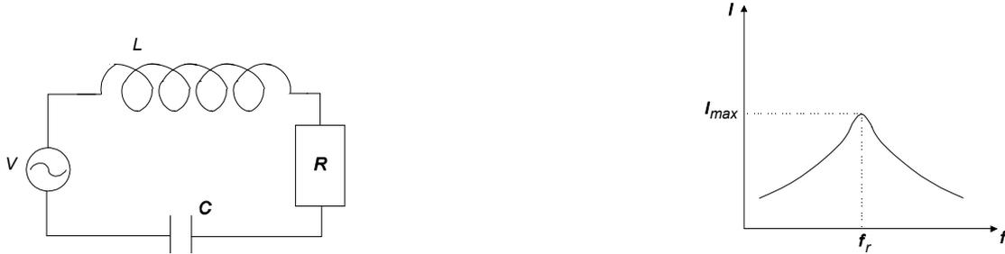
En este caso se combina el efecto de la bobina con el del condensador. La impedancia será:
