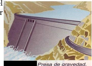
Todo dique debe permitir el escape del exceso de agua para evitar accidentes. El excedente de agua se puede eliminar a través de un aliviadero (por debajo de la cima de la presa), mediante un pozo de desagüe (interior del embalse) o por un túnel de desagüe (bordeando el dique) .
