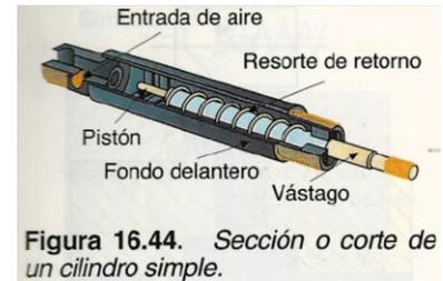
Figura 16.44. Sección o corte de un cilindro simple.
