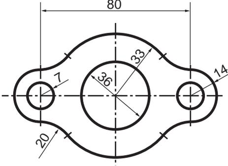
Dibujar a escala 2:1, a partir del punto O la BARRA DE TORNILLO DE BANCO representada.
