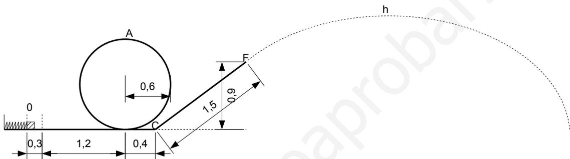
Como la parte superior del plano inclinado (0,90 m) está cerca del punto más alto del bucle (1,20 m), el punto más alto será probablemente el de la trayectoria parabólica.
