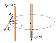
a) El sentido de los campos creados por los cables se obtiene por aplicación de la regla de la mano derecha.
