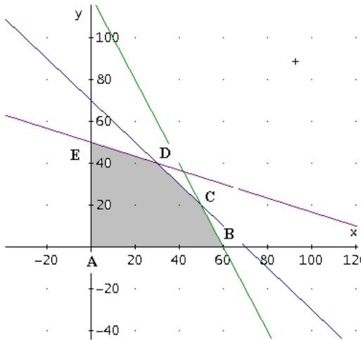
Resolviendo los sistemas correspondientes, obtenemos los puntos esquinas (puntos extremos): A (0,0), B (60,0), C (50,20), D (30,40) y E (0,50).
