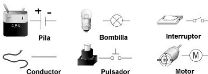
Los circuitos se representan mediante esquemas y hay tres tipos:
