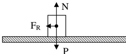
La única fuerza que frena al objeto es la fuerza de rozamiento:  $F_R = \mu \cdot N$ . La normal es igual al peso del objeto:  $N = P = m \cdot g = 100 \text{ kg} \cdot 9.8 \text{ m/s}^2 = 980 \text{ N}$ . Para aplicar el segundo principio de la dinámica necesitamos calcular el valor de la aceleración que experimenta el objeto.
