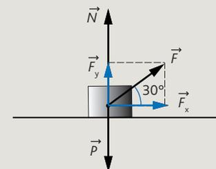
**7** Se tira del bloque del ejemplo anterior con la misma fuerza  $F = 60\text{ N}$ , pero en esta ocasión forma un ángulo de  $30^\circ$  con la horizontal en el sentido horario, tal y como muestra la figura. Calcula:
