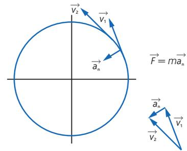
**FIGURA 5** Un objeto se mueve con un MCU. El módulo de su velocidad se mantiene constante, pero la dirección varía continuamente. El vector  $\Delta\vec{v}$  representa la variación de velocidad de  $\vec{v}_1$  a  $\vec{v}_2$ ; su dirección es radial y su sentido hacia el centro de la circunferencia que describe (sentido centrípeto). La aceleración correspondiente  $\vec{a}$  y la fuerza resultante  $\vec{F}$  son también radiales y centrípetas.
