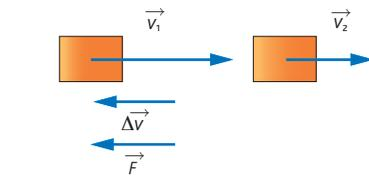
**FIGURA 4** Un objeto con trayectoria rectilínea frena disminuyendo el módulo de su velocidad de  $v_1$  a  $v_2$ . El vector  $\vec{F}$  tiene la misma orientación que  $\Delta\vec{v}$ , y por tanto que  $\vec{a}$  (horizontal hacia la izquierda).
