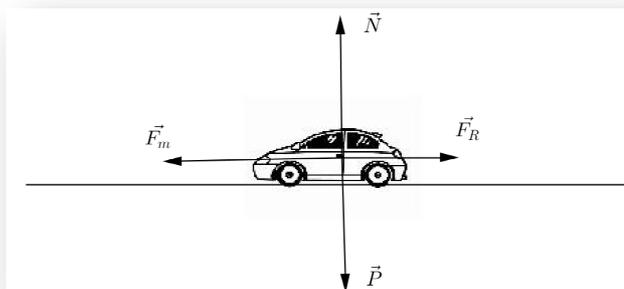
Analizamos las fuerzas que actúan en cada eje y a la resultante le aplicamos la segunda ley de Newton:
