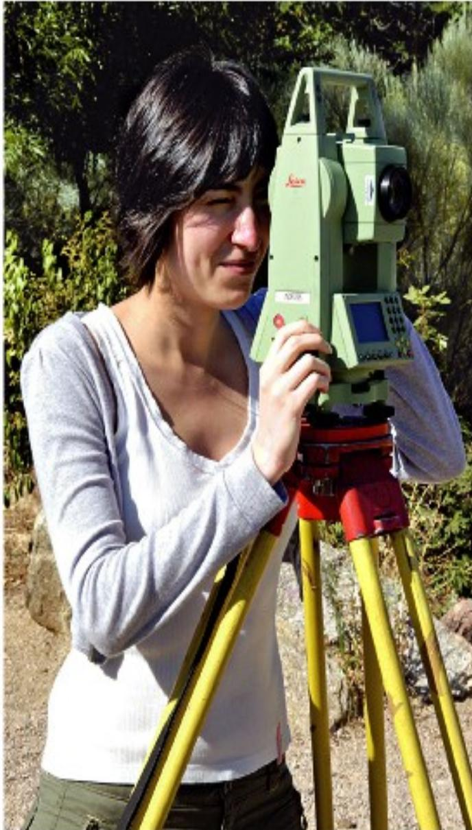
El **teodolito** es un instrumento que sirve para medir ángulos con gran precisión. Lo utilizan los topógrafos e ingenieros para medir pendientes y distancias.
