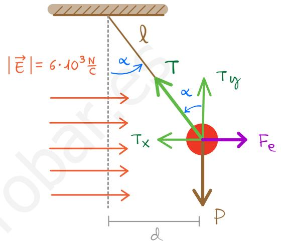
$$\text{Despejamos } \alpha = \arctg \frac{|q| \cdot E}{m \cdot g} = \arctg \left( \frac{8 \cdot 10^{-6} \text{ C} \cdot 6 \cdot 10^3 \frac{\text{N}}{\text{C}}}{4 \cdot 10^{-3} \text{ kg} \cdot 9,81 \text{ m/s}^2} \right) \approx 50,7^\circ$$
