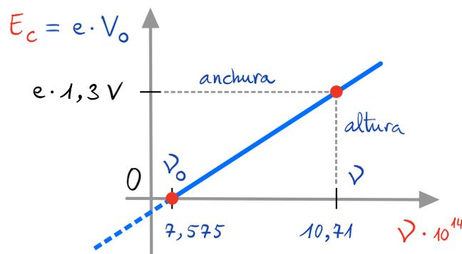
$h = \frac{\text{altura}}{\text{anchura}} = \frac{e \cdot V_0}{\nu - \nu_0} = \frac{1,6 \cdot 10^{-19} \text{ C} \cdot 1,3 \text{ V}}{10,71 \cdot 10^{14} - 7,575 \cdot 10^{14} \text{ Hz}} = 6,635 \cdot 10^{-34} \text{ J} \cdot \text{s}$
