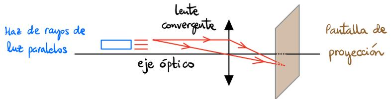
Despejamos la distancia focal  $\Rightarrow \frac{s - s'}{s \cdot s'} = \frac{1}{f'} \Rightarrow f' = \frac{s \cdot s'}{s - s'}$  Sustituimos los datos:
