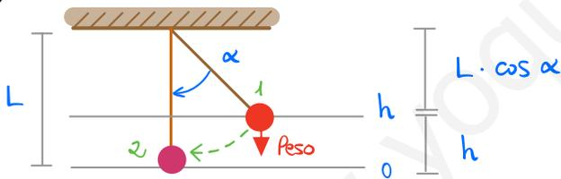
Resolvemos la caída por la conservación de la energía mecánica. Suponemos que  $g = \text{cte}$  por que la altura es pequeña y podemos utilizar las ecuaciones de Galileo del m.r.u.a.
