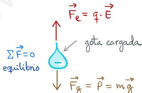
La lámina positiva se coloca en la parte superior para atraer la carga negativa y así compensar el peso.
