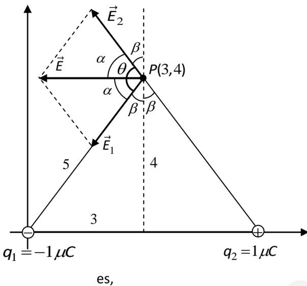
La figura muestra las intensidades de los campos creados por  $q_1$  y  $q_2$  en  $P$  y la intensidad del campo total, que es la suma vectorial de los anteriores.
