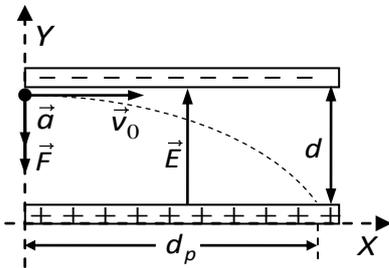
Sabemos que en dentro del condensador el campo eléctrico es constante y que está dirigido de la placa positiva a la negativa, como se ve en la figura. Por otro lado, de la ecuación  $F = qE$  deducimos que, puesto que la carga del electrón es negativa, la fuerza eléctrica tiene sentido opuesto al campo; es decir, es vertical y dirigida hacia abajo (ver figura). Observa que la ecuación está en su forma escalar porque la fuerza y el campo tienen la dirección del eje  $OY$ .
