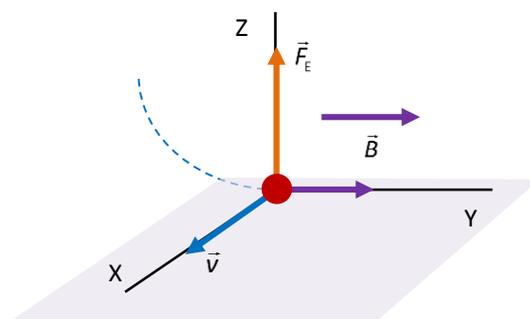
11. En una región del espacio donde existe un campo magnético uniforme en dirección perpendicular al plano del dibujo se introduce una carga eléctrica, con velocidad  $\vec{v}$  constante. Determina cuál debe ser el signo de la carga eléctrica para que esta se desvíe en el campo siguiendo la trayectoria indicada en la figura. Justifica la respuesta.
