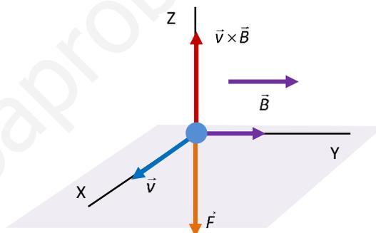
8. Un protón penetra con una velocidad  $\vec{v}$  en el seno de un campo magnético uniforme  $\vec{B}$ . Explica la trayectoria que seguirá el protón:
