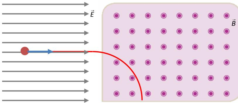
En la primera parte la partícula es acelerada debido a la existencia de un campo eléctrico. La diferencia de potencial es de 2500 V. Al principio, la partícula solo tiene energía potencial debido a esta diferencia de potencial al final de la zona donde está el campo eléctrico, solo posee energía cinética. Por tanto, aplicando el principio de conservación de la energía en la zona del campo eléctrico podemos calcular la velocidad que adquiere:
