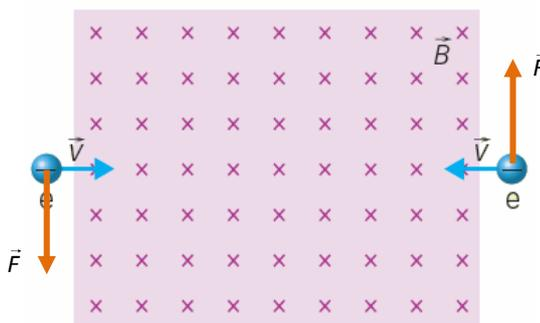
La fuerza es perpendicular tanto al campo magnético como a la velocidad de cada electrón y viene dada por la fuerza de Lorentz ( $\vec{F} = q \cdot \vec{v} \times \vec{B}$ ). En la imagen para el electrón que penetra con velocidad hacia la derecha, la fuerza tendrá un sentido vertical y hacia abajo, pues se trata de una partícula con carga negativa. Por tanto, este electrón girará hacia abajo, en el sentido de las agujas del reloj.
