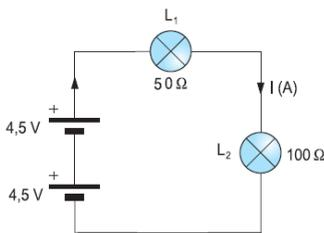
30. A partir del siguiente circuito, completa la tabla realizando para ello los cálculos necesarios si la corriente que proporciona la pila es de 0,5A:
