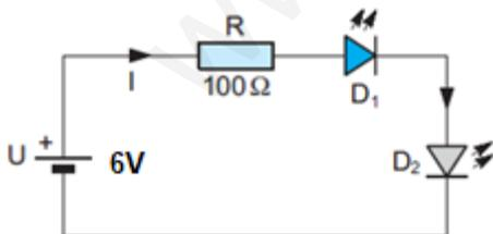
36. Completa la tabla indicando el estado de las lámparas y de los diodos semiconductores (0,7V) con ON y OFF según el pulsador accionado. ¿Cuál será la corriente que circula por las lámparas en cada caso si su resistencia es de 100  $\Omega$  ? Completa la tabla.
