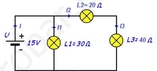
$$R_{eq} = \frac{60 \cdot 30}{60 + 30} = 20\Omega \rightarrow I = \frac{15V}{20\Omega} = 0,75A \rightarrow I_1 = \frac{15V}{30\Omega} = 0,5A \rightarrow I_2 = I - I_1 = 0,25A$$
