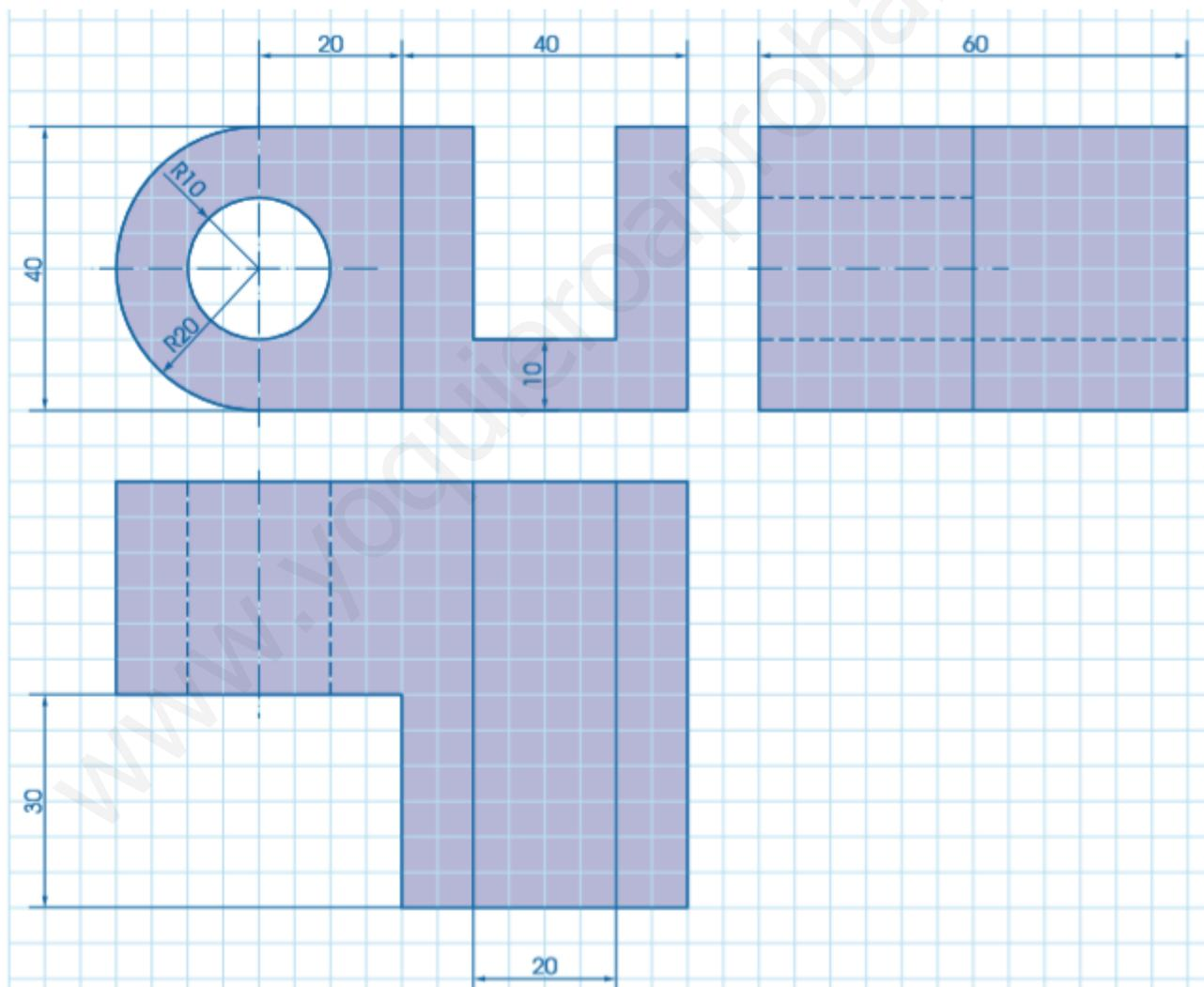
8. Dibuja las vistas de alzado, planta y perfil izquierdo de la pieza que se indica y acotar las vistas convenientemente. Tomar como vista de "alzado" la indicada con la flecha. Suponer que la cuadrícula es de 5 mm de lado.
