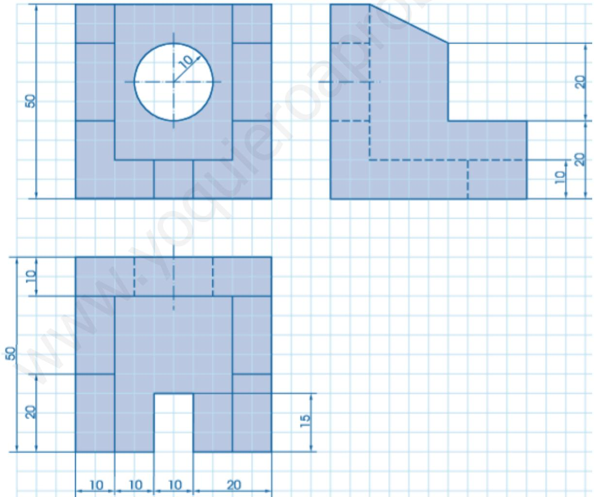
6. Dibuja las vistas de alzado, planta y perfil izquierdo de la pieza que se indica y acotar las vistas convenientemente. Tomar como vista de "alzado" la indicada con la flecha. Suponer que la cuadrícula es de 5 mm de lado.
