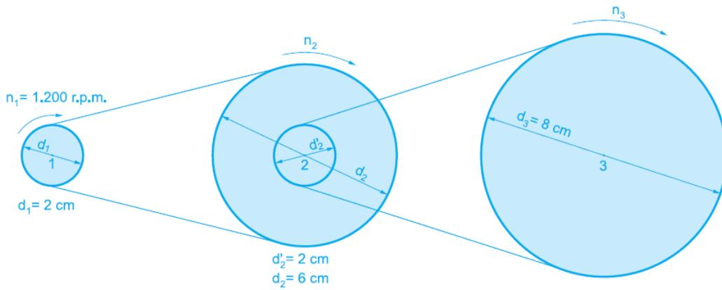
19. A continuación se muestra un sistema de transmisión compuesto mediante poleas. Completa la tabla de velocidades, sabiendo que el eje 1 (motriz) gira a 100 r.p.m. Completa la tabla.
