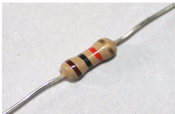
Aspecto de una resistencia fija. Observa los anillos de colores.
