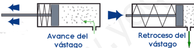
Fig 8: Principio de funcionamiento de un cilindro S/E con retorno por muelle
