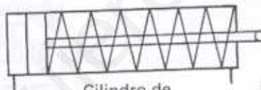
Cilindro de accionamiento único o efecto simple
