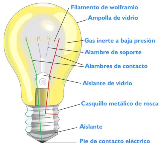
Fig 15: Esquema de una lámpara incandescente.
