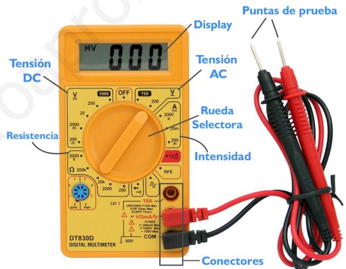
El polímetro posee una punta de prueba roja y otro negra. El **terminal negro se conectará siempre en la conexión marcada como COM (común)**, mientras que la **conexión roja dependerá de lo que se quiera medir: voltaje (V), intensidad (mA) o resistencia ( $\Omega$ )**.
