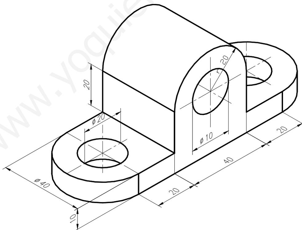
6. Dibuja las vistas de las piezas siguientes, aplicando la escala que se indica junto a ellas. Acótalas correctamente.
