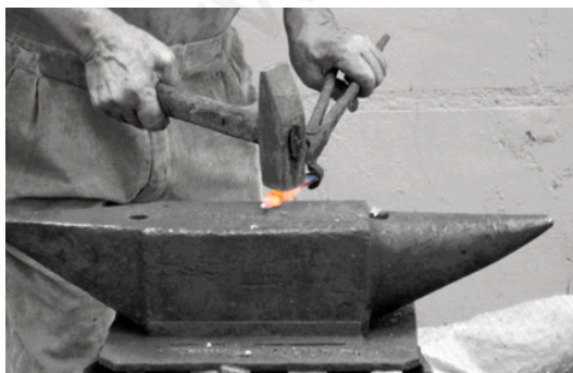
Fig 15: Forjado manual empleando las tenaza, martillo y yunque.
