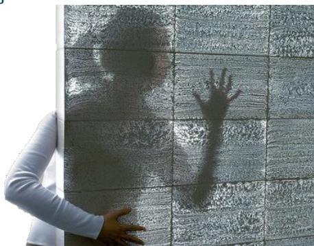
Fig 1: Concreto translúcido: Es una mezcla de fibra óptica y hormigón.
