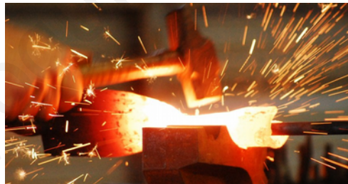
El acero se forja a altas temperatura golpeándolo con un martillo.
