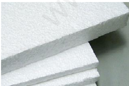
POREXPAN (mal conductor térmico, buen aislante térmico)
