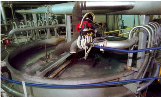
previamente descortezados, troceados. Estos trozos se depositan en un recipiente lleno de agua, al que se añaden otras sustancias químicas. De esta manera, se consiguen separar las fibras de celulosa de la parte leñosa y de la lignina (cola natural que une las fibras de la madera). Esta pasta, que es de celulosa casi pura, es fina y muy apreciada.
