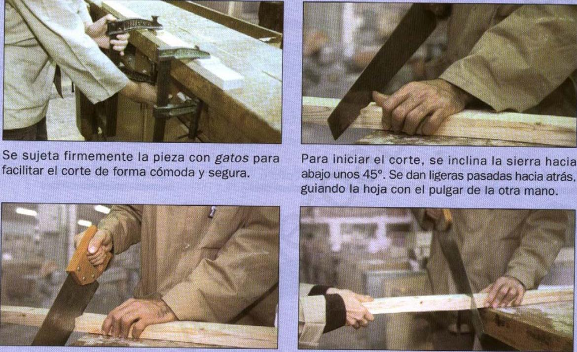
Se sujeta firmemente la pieza con *gatos* para facilitar el corte de forma cómoda y segura.
