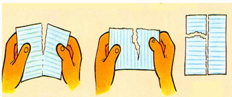
Las máquinas actuales de fabricación del papel, a diferencia de cuando se hacía anualmente, colocan siempre las fibras paralelas en el sentido de desplazamiento de la hoja. Para saber en qué
