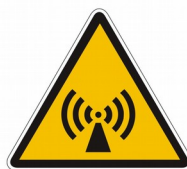
Peligro por radiaciones no ionizantes
