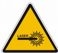
Peligro por radiaciones láser
