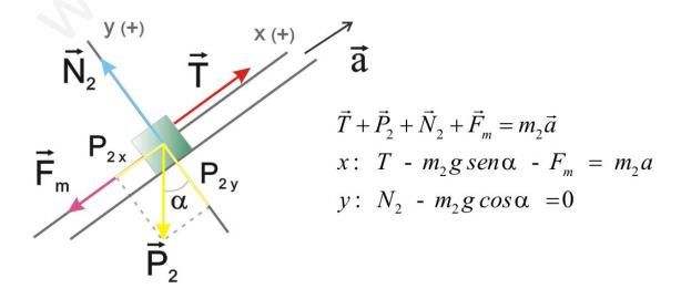
b) Calcular la aceleración de los bloques y la tensión en la cuerda cuando el muelle se ha estirado una longitud x = 0.03m con respecto a su longitud de equilibrio.
