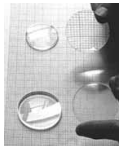
FIGURA 8-29 a) Lentes convergentes y b) lentes divergentes, mostradas en sección transversal. c) Fotografía de una lente convergente (izquierda) y de una lente divergente (derecha). d) Lentes convergentes (arriba) y lentes divergentes (abajo), planas y elevadas sobre el papel para formar imágenes.
