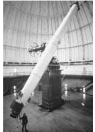
FIGURA 9-20 Este gran telescopio refractor se construyó en 1897 y se alberga en el Observatorio Yerkes, en Wisconsin. La lente del objetivo tiene 102 cm (40 pulgadas) de diámetro y el tubo del telescopio mide aproximadamente 19 m de largo. Ejemplo 9-8.
