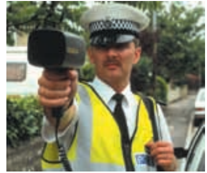
10.16 Este cañón manual de radar emite un haz de radio de frecuencia f_0 , el cual, en el marco de referencia de un automóvil que se aproxima, tiene una frecuencia f más alta dada por la ecuación (10.25). El haz reflejado también tiene una frecuencia f en el marco del auto, pero tiene una frecuencia f' aún más alta en el marco del policía. El cañón de radar calcula la rapidez del auto comparando las frecuencias del haz emitido y del haz doblemente reflejado y con desplazamiento de Doppler.
