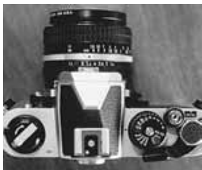
FIGURA 9-4 En esta cámara, los números “ f ” y el anillo de enfoque están en la lente de la cámara. La rapidez del obturador se selecciona en la pequeña rueda en la parte superior del cuerpo de la cámara.
