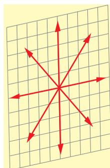
Los vectores que aparecen en la figura corresponden a distintos campos eléctricos que están oscilando, desplazándose en una dirección perpendicular al plano mostrado. Por tanto, hay cuatro direcciones de vibración (cada una de ellas contiene dos vectores opuestos).
