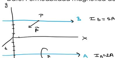
$$a) \text{ campo magnético: } \beta = \frac{\mu_0 \cdot I}{2\pi \cdot r} \quad r = 8 \text{ m (distancia entre hilos)}$$
