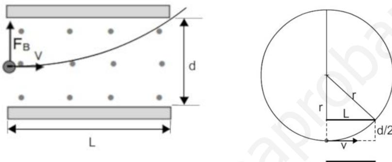
La trayectoria seguida por el electrón será un arco de círculo y para que libere justamente la placa superior, ha de suceder lo que se indica en el esquema de la derecha. Por tanto:
