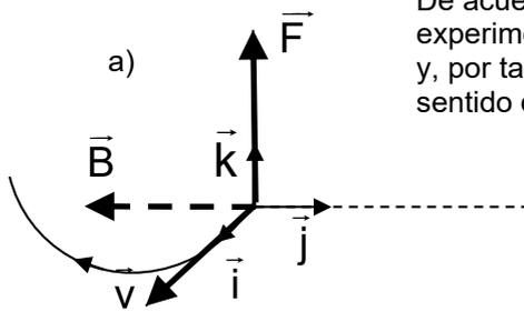
De acuerdo con el esquema que se muestra el electrón (carga negativa) experimentará una fuerza  $\vec{F} = q(\vec{v} \wedge \vec{B})$  dirigida en el sentido positivo del eje Z y, por tanto, describirá una trayectoria circular (situada en el plano XZ) en el sentido de las agujas del reloj de radio:
