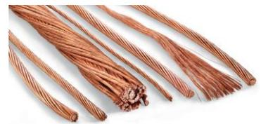
**Cobre.** Es buen conductor y fácil de trabajar. Con él se hacen tubos y cables.
