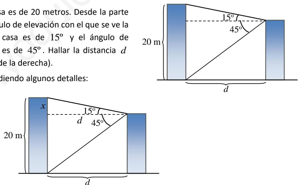
Hemos llamado  $x$  a la diferencia de altura entre los dos edificios. Adem\u00e1s, la distancia  $d$  tambi\u00e9n es la longitud de la l\u00ednea discontinua, que divide al tri\u00e1ngulo central en dos tri\u00e1ngulos rect\u00e1ngulos. Usando estos dos tri\u00e1ngulos rect\u00e1ngulos podemos establecer y resolver el siguiente sistema de ecuaciones.
