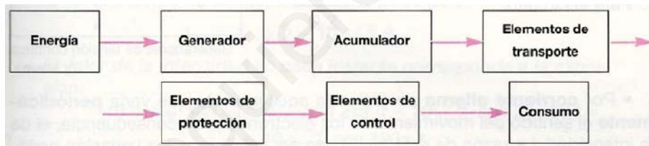
El elemento **generador** se encarga de transformar la energía de entrada al circuito, para poner en movimiento las cargas eléctricas o el fluido. Es el elemento **activo** del circuito, a diferencia de todos los demás, que son **pasivos**.
