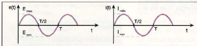
Y donde se denomina **frecuencia, f**, de una corriente alterna al número de veces que, por unidad de tiempo, se modifica el sentido del movimiento de los electrones. La frecuencia se mide en ciclos/s o hercios (Hz).
