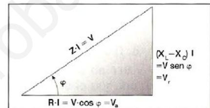
Triángulo de tensiones.
