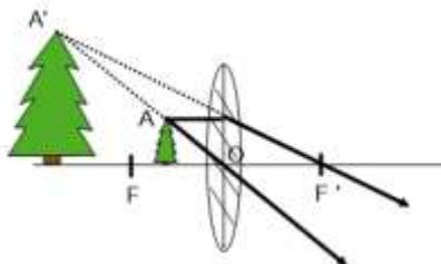
a) Indique razonadamente, ayudándose de un esquema, las características de la imagen que se obtiene al colocar un objeto luminoso: i) en el foco objeto de una lente convergente; ii) en el foco imagen de una lente divergente.
