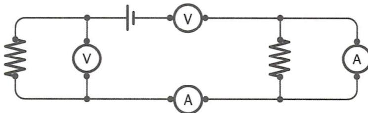
El amperímetro de la derecha se ha conectado en paralelo, en lugar de conectarlo en serie. En cambio, el voltímetro de la parte superior del dibujo se ha conectado en serie, en lugar de conectarlo en paralelo. Los restantes aparatos se han conectado correctamente.
