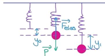
El trabajo externo realizado para deformar el muelle coincide con la variación de energía potencial:  $W_{0 \rightarrow 1}^{\text{ext.}} = \Delta E_p$
