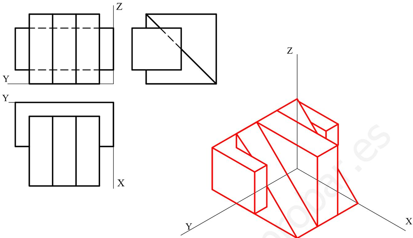
**B4.-** Representar las vistas necesarias de la pieza, dada en dibujo isométrico (sin coeficientes de reducción), incluyendo las secciones que se consideren oportunas. Acotar según norma para su correcta definición dimensional, sabiendo que los taladros son pasantes.
