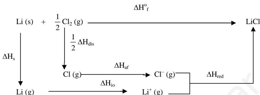
$\Delta H_f = \Delta H_s + \Delta H_{\text{io}} + \frac{1}{2} \cdot \Delta H_{\text{dis}} + \Delta H_{\text{af}} + \Delta H_{\text{red}}$  y despejando la energía de red:
