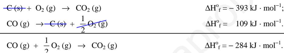
Al ser esta energía la desprendida en la combustión de un mol de CO, la combustión de 56 g desprende la energía:  $56 \text{ g CO} \cdot \frac{1 \text{ mol CO}}{28 \text{ g CO}} \cdot \frac{-284 \text{ kJ}}{1 \text{ mol CO}} = -568 \text{ kJ}.$
