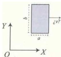
se mueve con una cierta velocidad  $v$  respecto a un sistema de referencia OXY que consideramos fijo. El cociente entre el área  $A$  que mide un observador fijo OXY y el área  $A_p$  que mide un observador que viaja junto con el rectángulo es  $A/A_p = 0,6$ . Calcular, en función de la velocidad de la luz  $c$ , la velocidad  $v$  con la que se mueve el rectángulo respecto a OXY. En la figura la longitud propia de la base del rectángulo es  $a$  y su altura es  $b$ .
