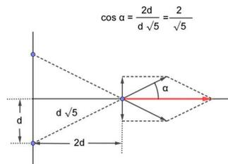
zado a la posición  $x = 2d$ , las componentes verticales de la fuerza debida a cada una de las otras dos cargas se anulan entre sí, por lo que la fuerza resultante sobre la carga situada en  $2d$  será:
