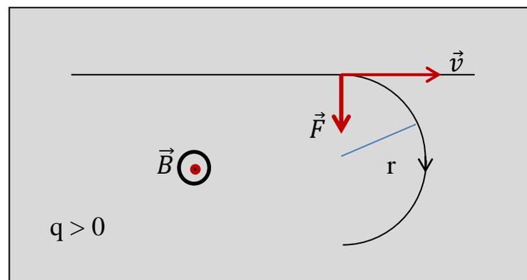
$$F_B = F_c \quad |q| \cdot v \cdot B = \frac{m \cdot v^2}{r} \quad r = \frac{m \cdot v}{|q| \cdot B} \quad v = \frac{L}{T} \quad T = \frac{L}{v} = \frac{2\pi \cdot r}{v} = \frac{2\pi \cdot m}{|q| \cdot B}$$
