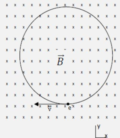
La Fuerza magnética que actúa sobre el electrón viene dada por la Ley de Lorentz. Si observamos la figura vemos que el campo magnético está dirigido en el sentido negativo del eje z, y la velocidad el negativo del eje x. Por tanto:
