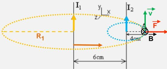
Las líneas del campo magnético que son creadas por una corriente rectilínea forman circunferencias concéntricas en el plano perpendicular al conductor. La dirección del campo magnético es tangente en cada punto a dichas líneas, y su sentido es el que determina la regla de la mano derecha (pulgares en dirección de la intensidad).
