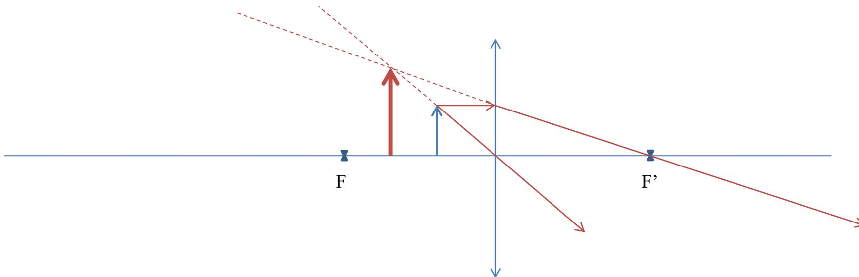
El objeto debe situarse en el foco para que la imagen se forme en el infinito.  $s = -2 \text{ cm}$ .
