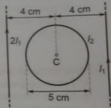
a) La intensitat  $I_1$  que ha de passar pel fil dret perquè el mòdul del camp magnètic en el punt C a causa dels corrents dels dos fils rectes valgui  $12 \mu\text{T}$ . (1 punt)
